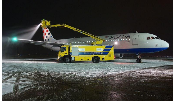
Figure I.15: un antigivrage revêtement sur la surface de l'avion. [16]
