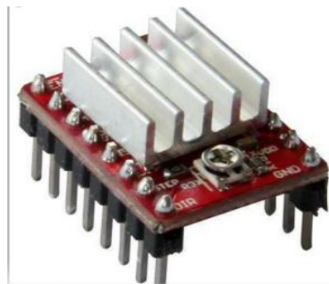
Figure II.8 : Dissipateur de chaleur A4988.
