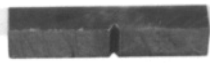
Fig. 4-3: prise de vue d'une éprouvette de flexion en 3 points pour essais destructifs.
