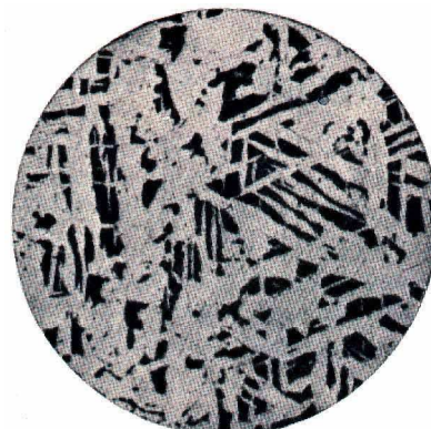
Fig.1.6.-Transformations structurales dans la ZAT : représentation schématique et micrographies. Dans la Zone1 : \theta < 600^\circ et dans la Zone3 : Ac3 > \theta > Ac1 et dans la (zone de liaison) Zone2 : \theta > 1200^\circ structure à gros grains
