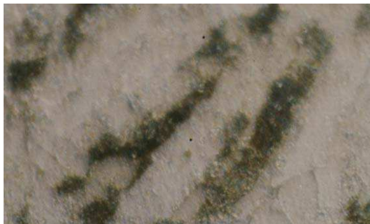
fig 5.7 - Micrographie du métal de base, prise à 5mm du bout de l'éprouvette sur l'échantillon 2, 500x. (Photo 30- p1)
