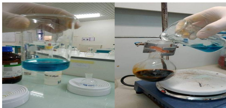
Figure III. 1 : La complexation des ligands azoïques avec l'acétate de cuivre (II)
