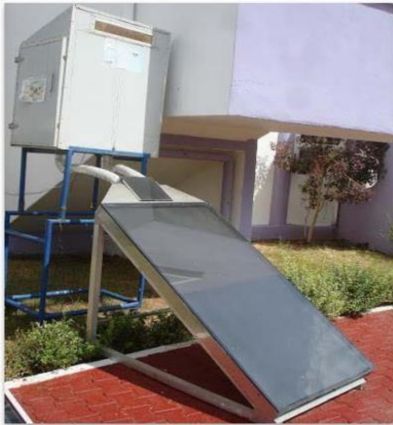
Figure II.21 Séchoir solaire indirect destiné au séchage des PAM
