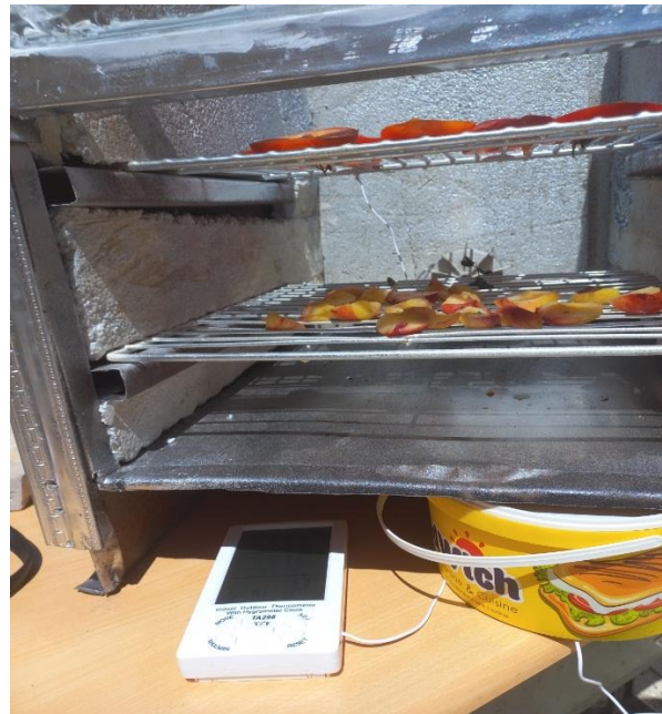
Figure III.9 Aperçu de l'intérieur du séchoir solaire avec deux supports
