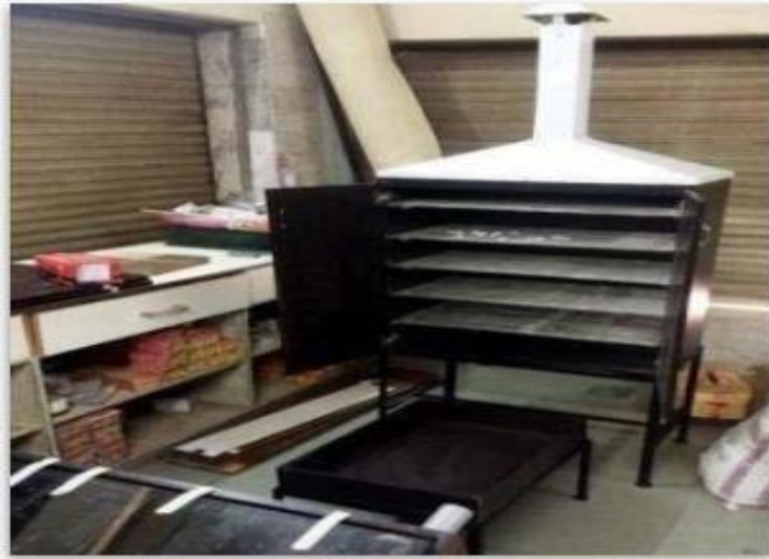
Figure II.9 Séchoir solaire "cheminée".
