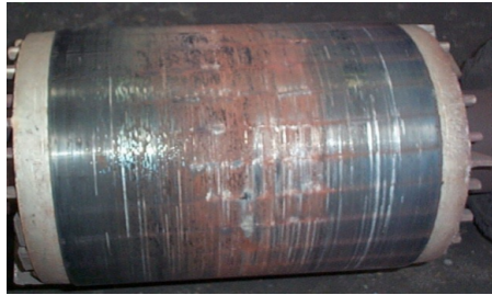
FIGURE II.5 – Rotor d'une moteur à induction dans les cas d'excentricités
