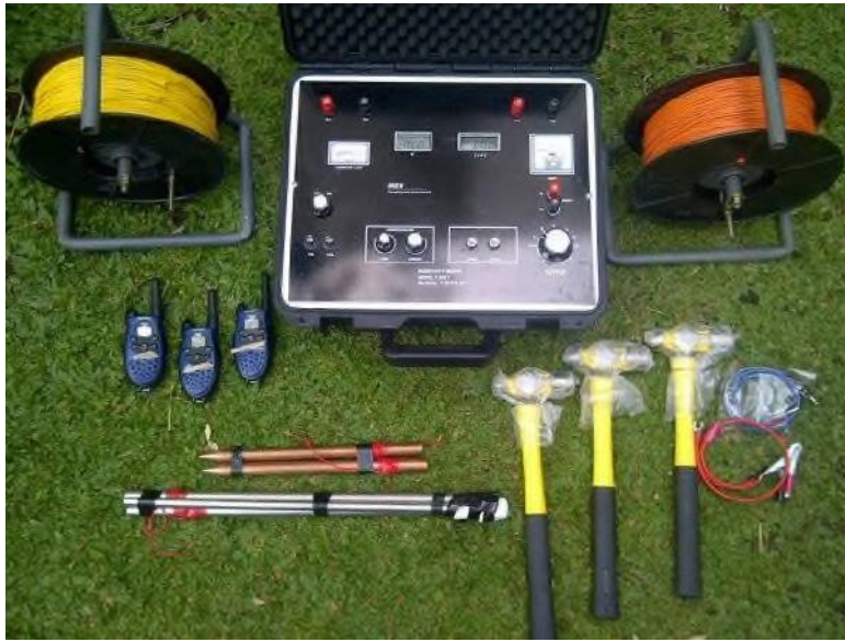
Figure 30: Les matériels de sondages électriques.
