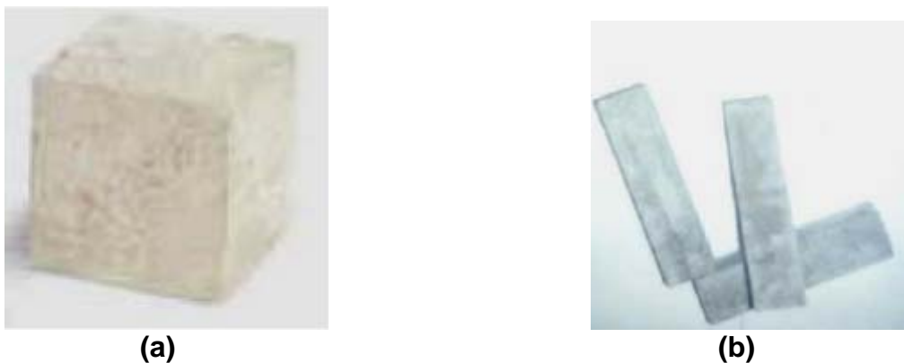
Figure D.4 – (a) échantillons cubiques de pâte de ciment (240); (b) échantillons prismatiques de mortier de ciment (12).
