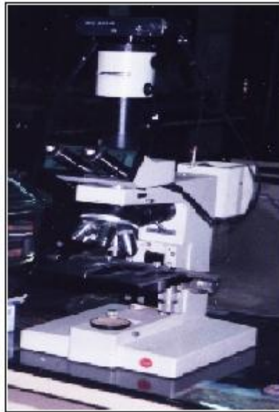
Figure IV.10 : Microscope métallographique optique
