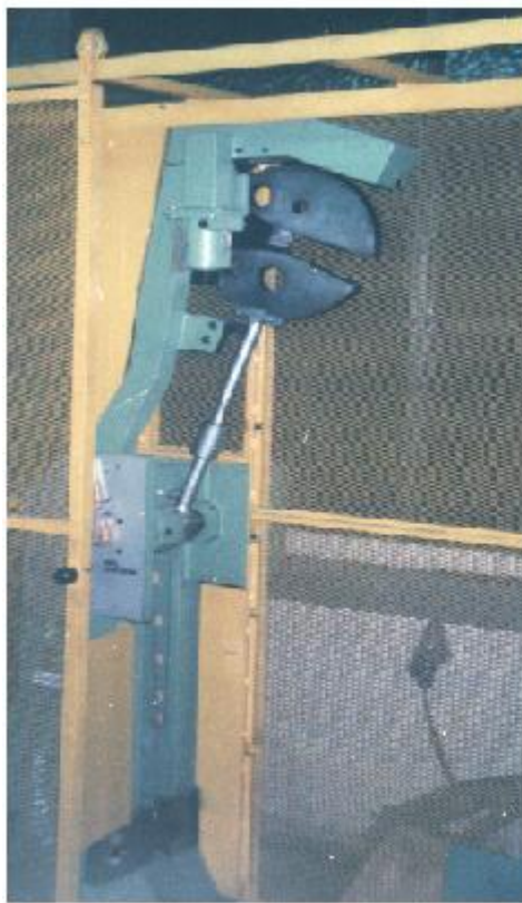
Figure IV.21 : Machine d'essai de résilience « Mouton de Charpy »
