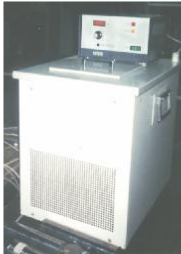
Figure IV.20 : Machine pour refroidissement des éprouvettes « Mini CRYOSTAT»
