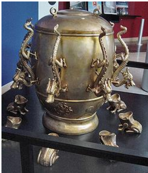
FigureI.1 : Réplique du sismoscope de Zhang Heng.
