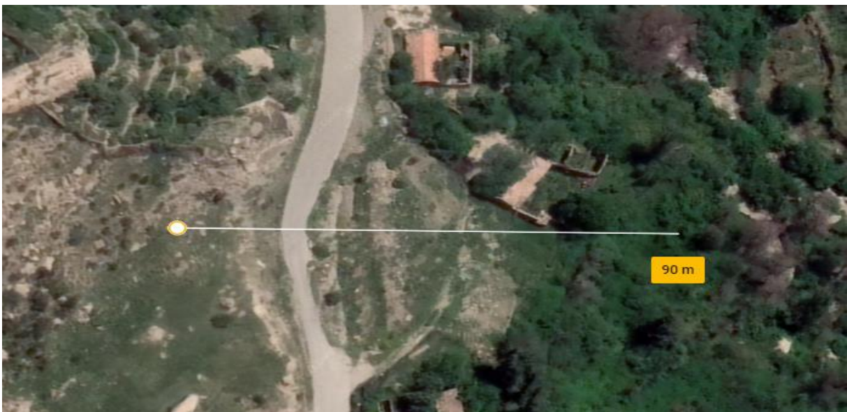
Figure3.2 : Longueur (90m) de glissement (Google Earth).
