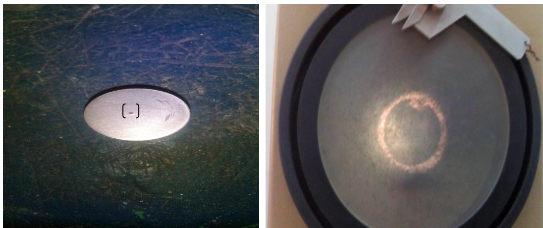
Figure III.4 L'effet de pénétrateur( cône) sur les pièces
