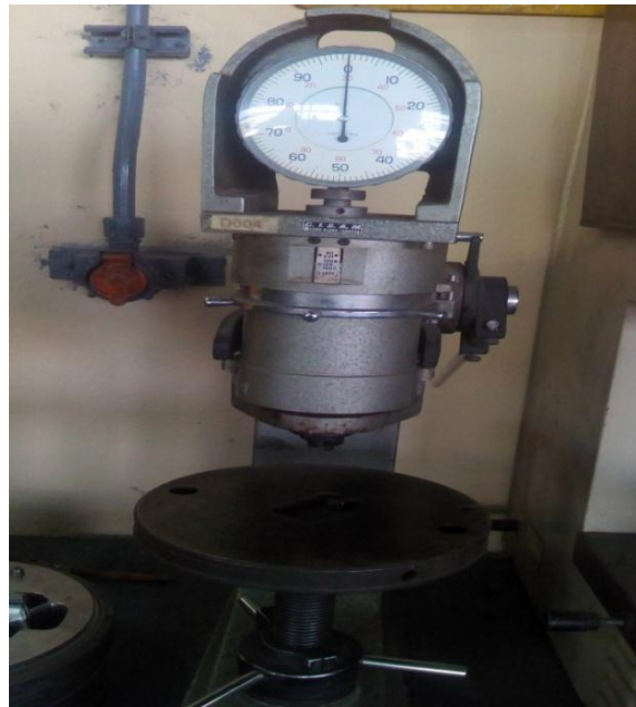
Figure III.3 : Schéma de principe d'un essai de dureté Rockwell
