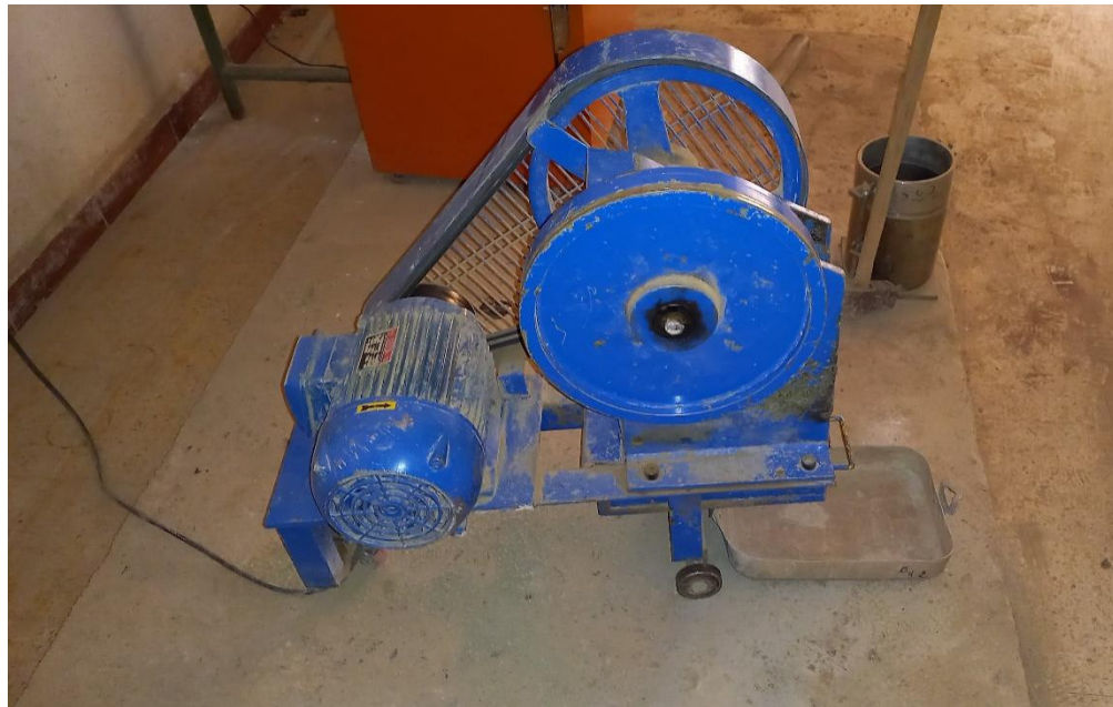
Figure III.13.: Étapes de préparation des granulats du béton de démolition..
