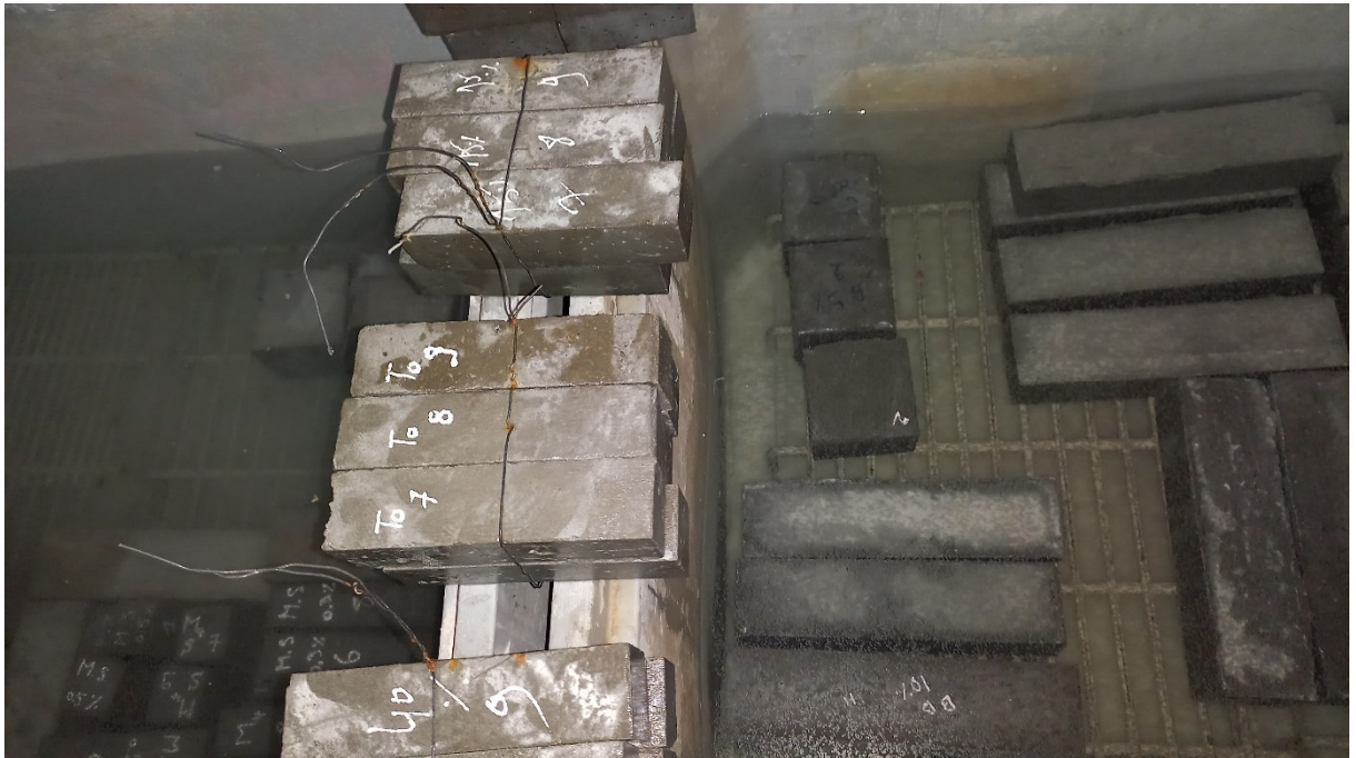
Figure III.22: Conservation dans l'eau à 20°C
