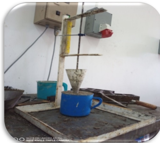
Figure.III.23 Cône d'Abrams du mortier (Laboratoire de génie civil M'sila)
