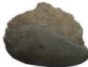
Figure II.4 : un granulat recyclé (granulat naturel entouré de mortier adhérent)
