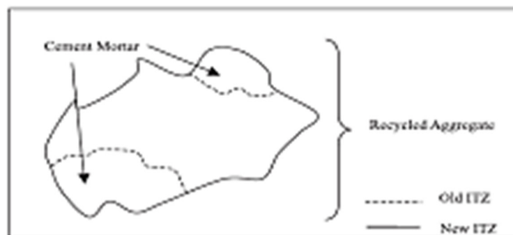
Figure II.3 : schématisation d'un granulat recyclé [Tam et al. 2005]
