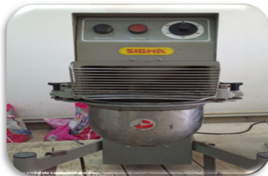
Fig.III.19 Malaxeur du mortier (Laboratoire de génie civil M'sila)
