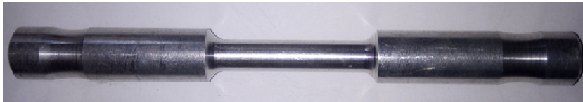
Figure(IV.7) : Epreuve cylindrique
