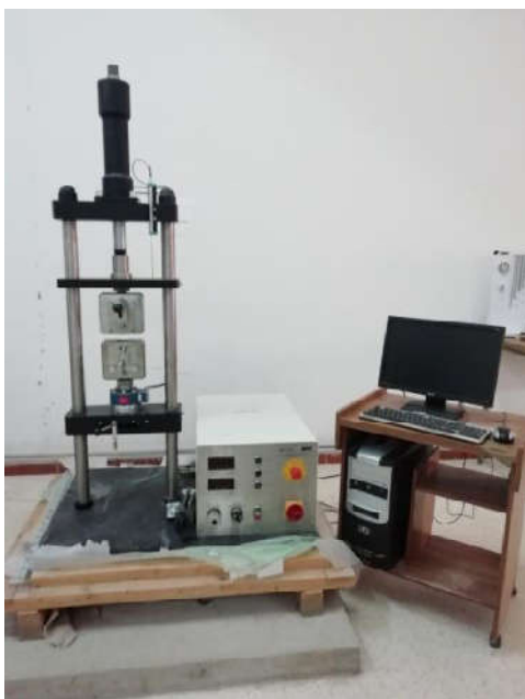
Figure (IV .4): System d'acquisition de données de la machine d'essai WP 310
