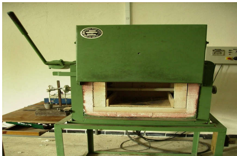
Figure.II.1 : Four de trempe
