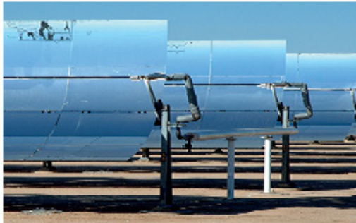
Capteurs thermodynamique cylindro-paraboliques
