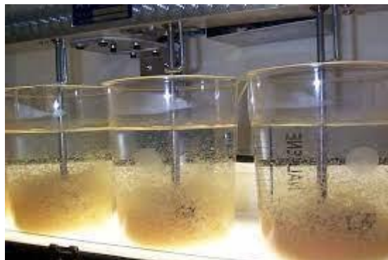
Figure II.3 : Traitements des eaux usées par La floculation/Coagulation/décantation
