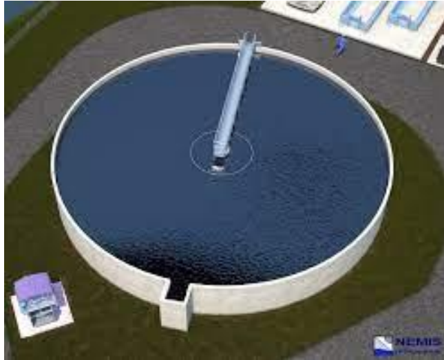
Figure II.6 : Clarificateur (clarification des eaux usées de la boue)
