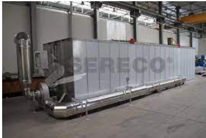
Figure II.9 : Biofiltre pour le traitement des odeurs
