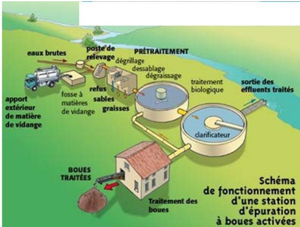
Figure III. 1 : Schéma de fonctionnement d'une station d'épuration
