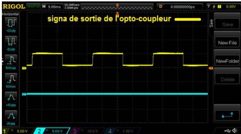
Figure III.7 Signal de sortie de l'opto-coupleur.
