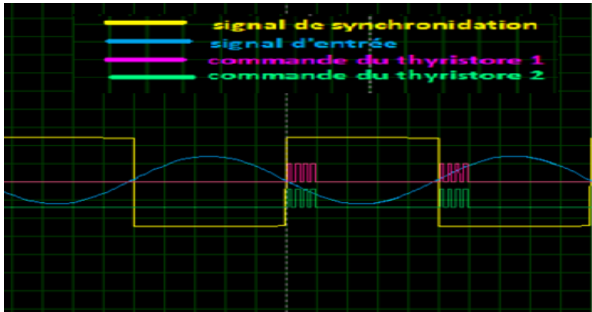
Figure II.14 Allures des signaux d'entrée de synchronisation et de commande pour le mode#2.
