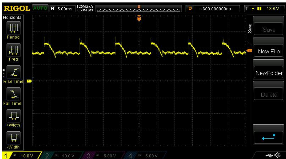
Figure III. 31 L'allure de la tension obtenue aux bornes du moteur DC.
