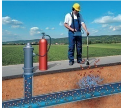
Fig. II. 7. Une détection par gaz traceur
