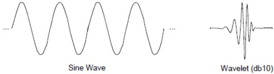
Fig. III.4. La différence entre une onde sinusoïdale et une ondelette
