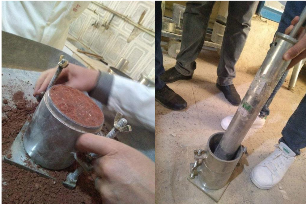
Figure II.6 : Appareillage et Echantillonnages d'essai Proctor.
