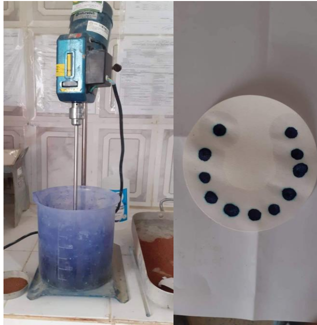
Figure II.5 : Appareillage et Echantillonnages d'essai VBS.
