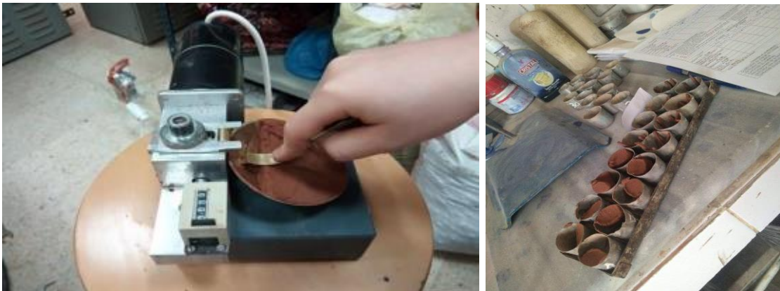
Figure II.4 : Appareillage d'essai limite d'Atterberg.
