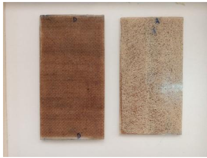
Fig.II.21. Plaques après démoulage (Jute – Luffa).
