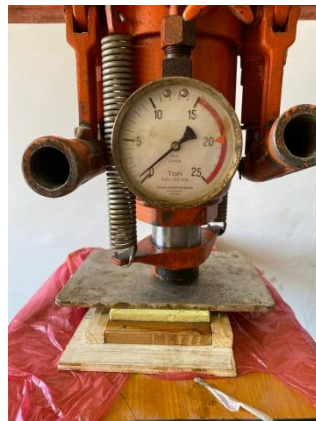
Fig.II.20. Moule en bois avec plaque sous presse hydraulique.
