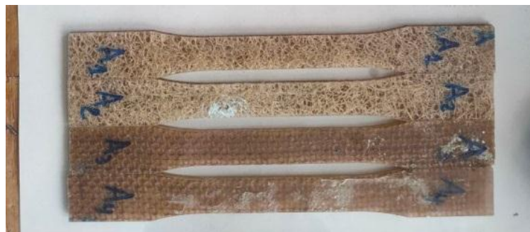
Fig.II.25. Les échantillons après usinage selon la norme ASTM-D638-03.
