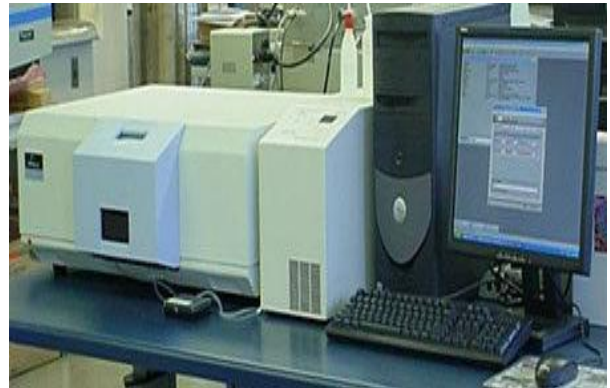
Figure II.13. Expérience typique d'une mesure de spectre de photoluminescence (a), spectromètre de luminescence Perkin Elmer LS 50 B (b).
