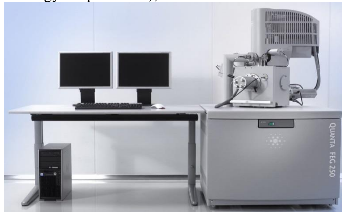
Figure II.11 microscope électronique à balayage de type MEB-EDX Quanta 250
