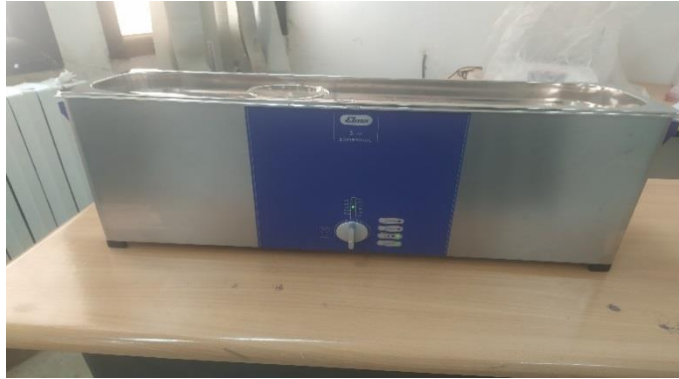
Figure II.4. Etapes de nettoyage des substrats au bain à ultrasons
