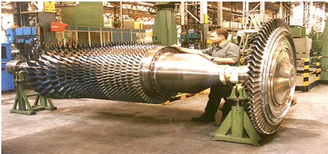
Figure III:5 Rotor du Compresseur de la turbine à gaz MS 5001
