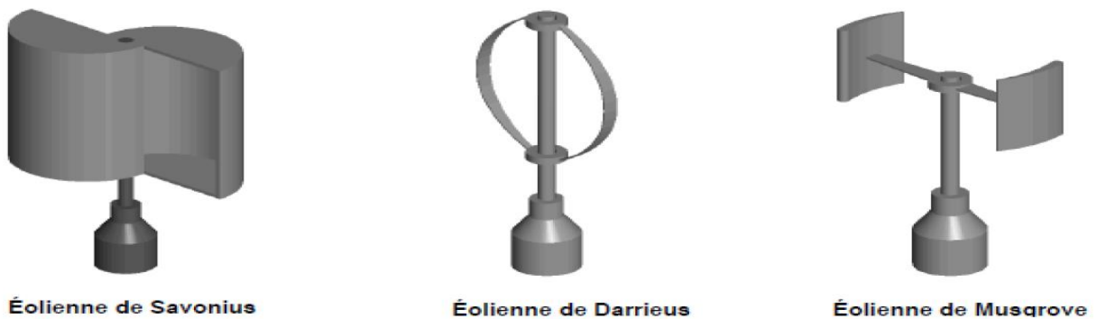
Fig.I.3. Eolienne à axe vertical
