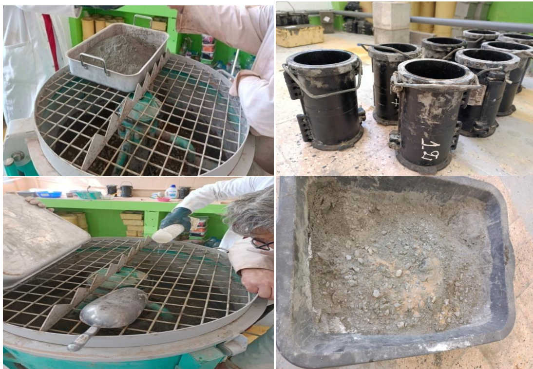
Figure III.21 la Confection des éprouvettes( Laboratoire Développement des Géo Matériaux)
