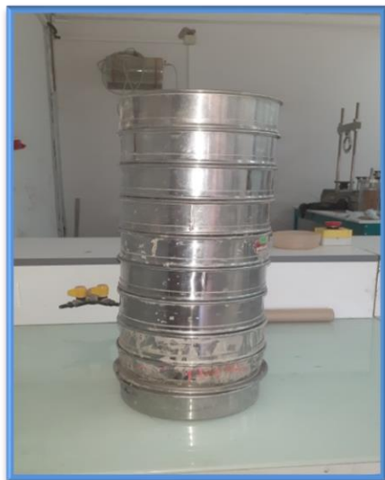
Figure II- 2: Une série de tamis pour l'essai de l'analyse granulométrique.
