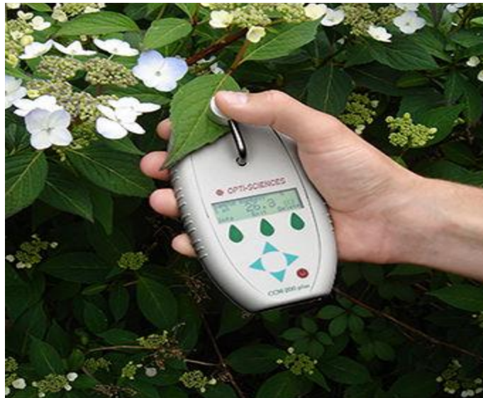
Figure.22 Mesure de la chlorophylle à l'aide d'un chlorophylle-mètre (Agro-Expo photo)
