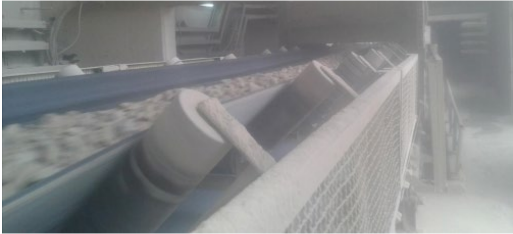
Fig. II. 3 Fixation des rouleaux sur la station-support [22].
