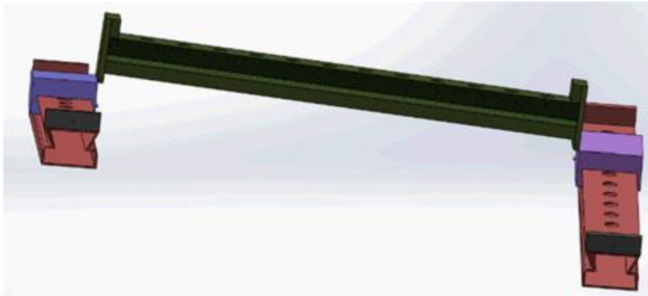
Figure III.9. Erreur de roulis due à des guidages verticalement non parallèles [41]
