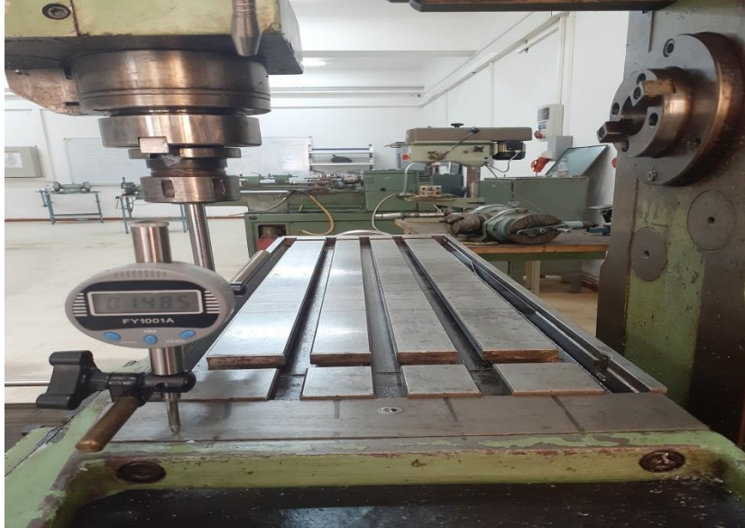
Figure.IV.4. Installation du comparateur digital sur la machine.
