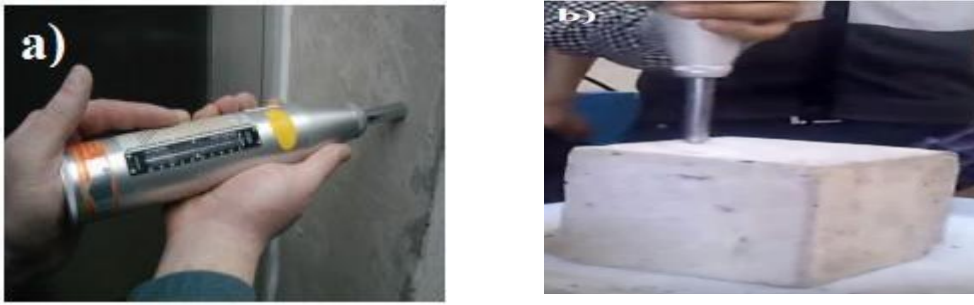
Figure II.6: a) Mesure sur surface béton, b) sur éprouvette cubique (10*10*10) cm 3 [19].
