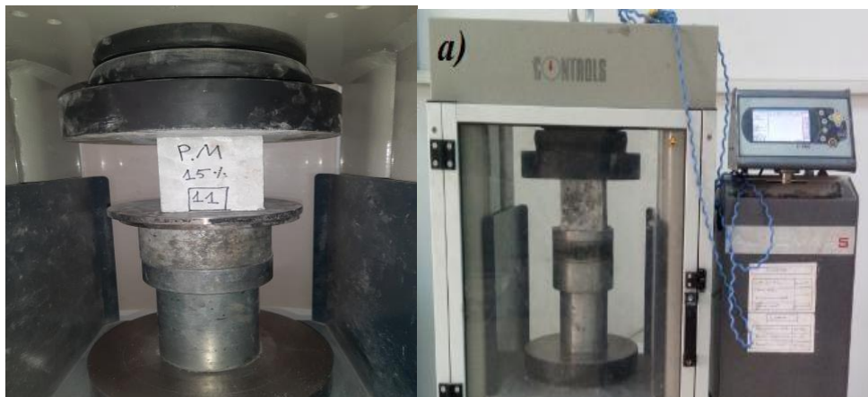
Figure IV.4: Essai compression : a) machine et éprouvette, b) éprouvette détruite.
