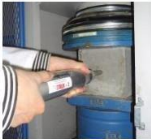
Figure IV.6 :Principe de l'essai scléromètre.
