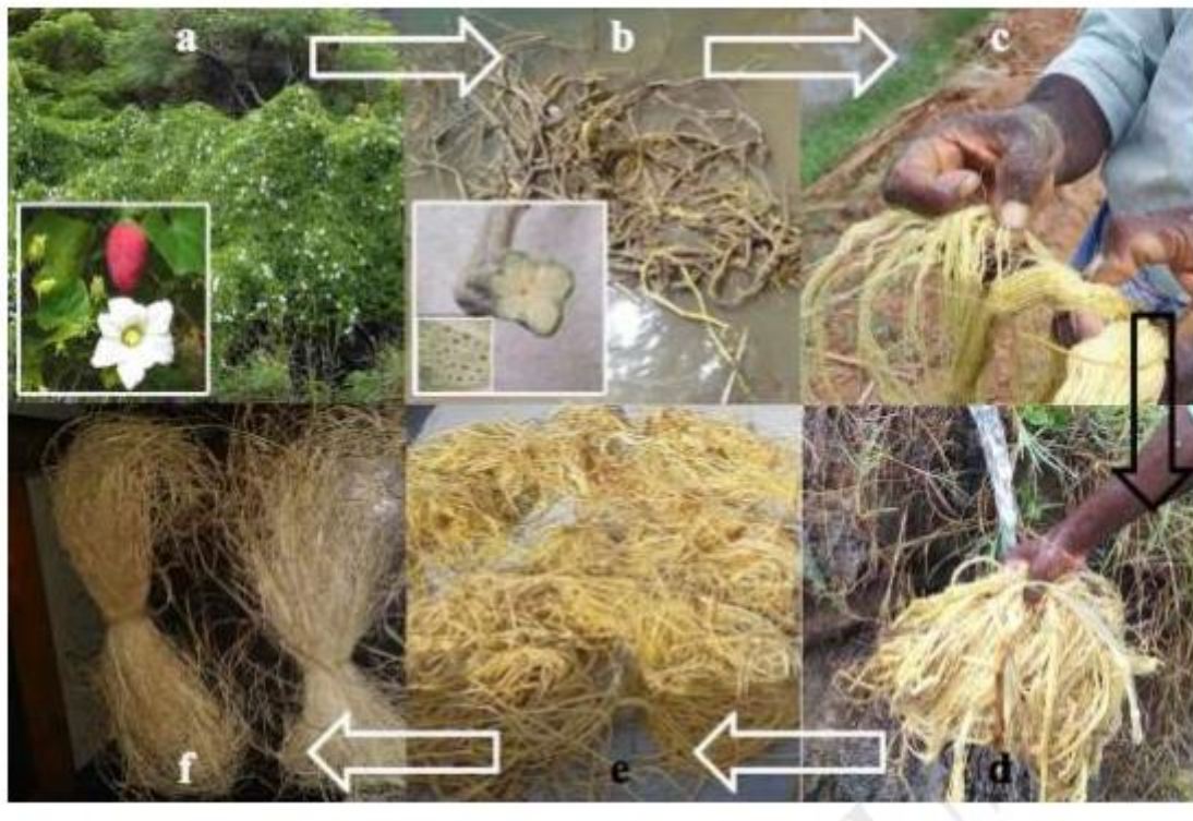
Figure. I. 9 : (a) Coccinia grandis .L plante, fruit et fleur, (b) rouissage à l'eau, coupe transversale vue de la tige et des faisceaux de fibres internes, (c) Fibres internes retenues (après rouissage), (d) lavage dans de l'eau propre, (e) Séchage (lumière du soleil), (f) CGF (après traitement au NaOH) [30]
