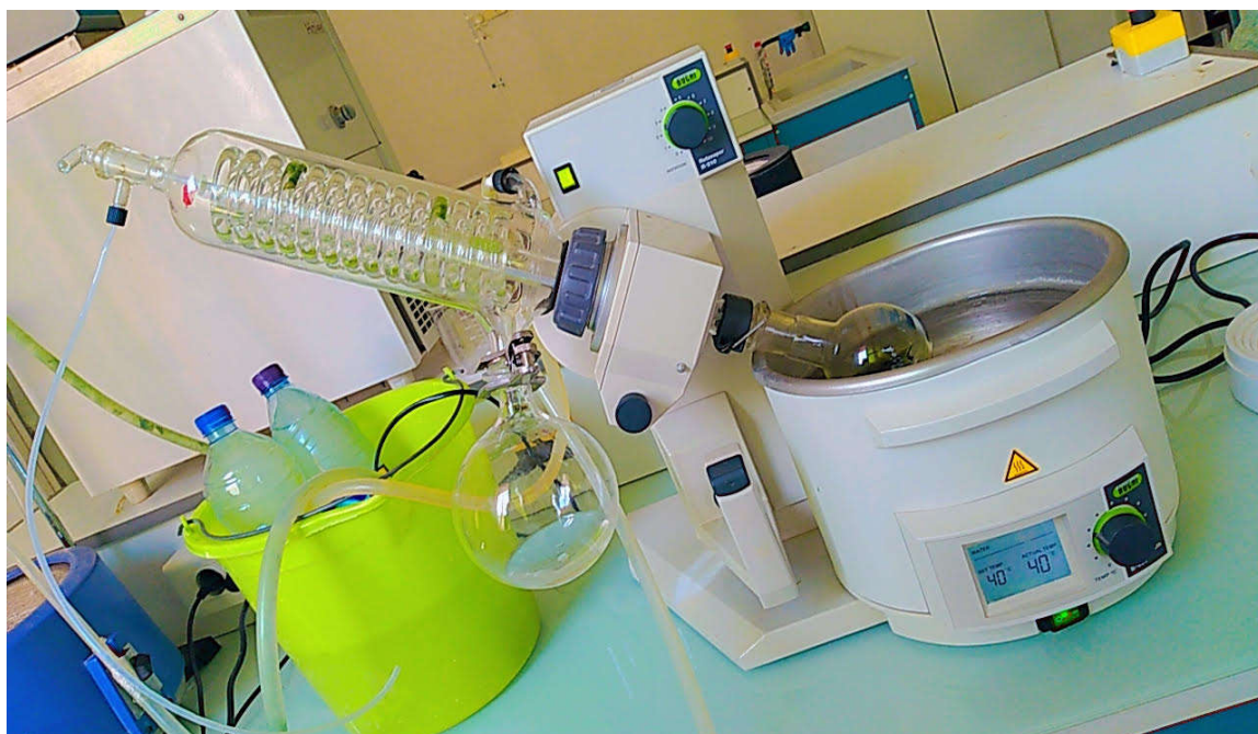
Figure 3.5: Montage de Rota-vapeur utilisé pour obtenir l'extrait brut
