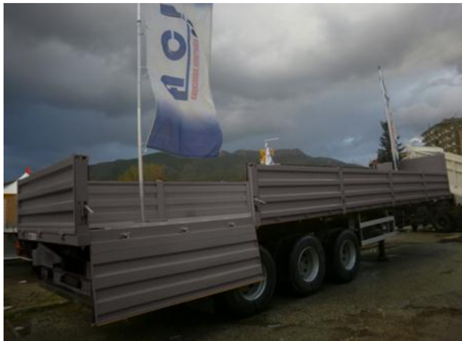
Figure I-29: L'installation des portes latérales et la porte arrière de la remorque
