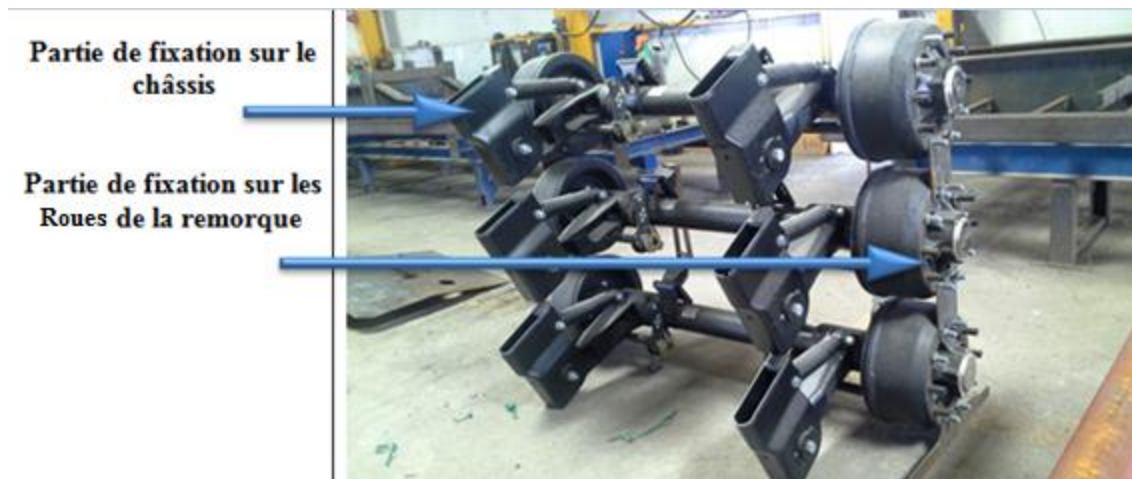
Figure I-19: les supportes des roues.
