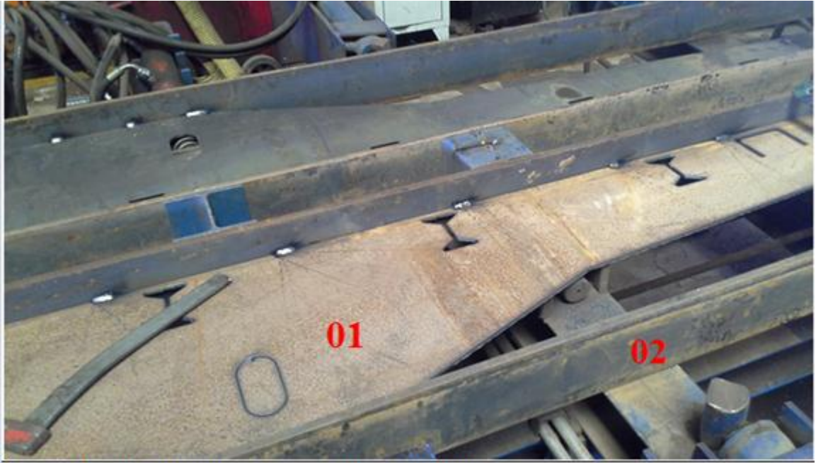
Figure I-8: Soudage des feuilles métalliques - ACI de M'sila
