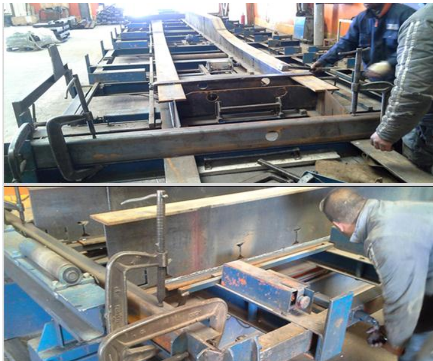
Figure I-13: Méthode de fixation des travers sur le gabarit
