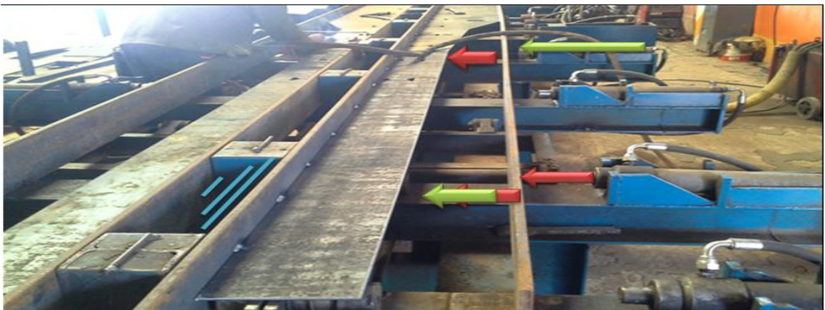
Figure I-9: Gabarit au cours de fixation des pièces mécaniques.
