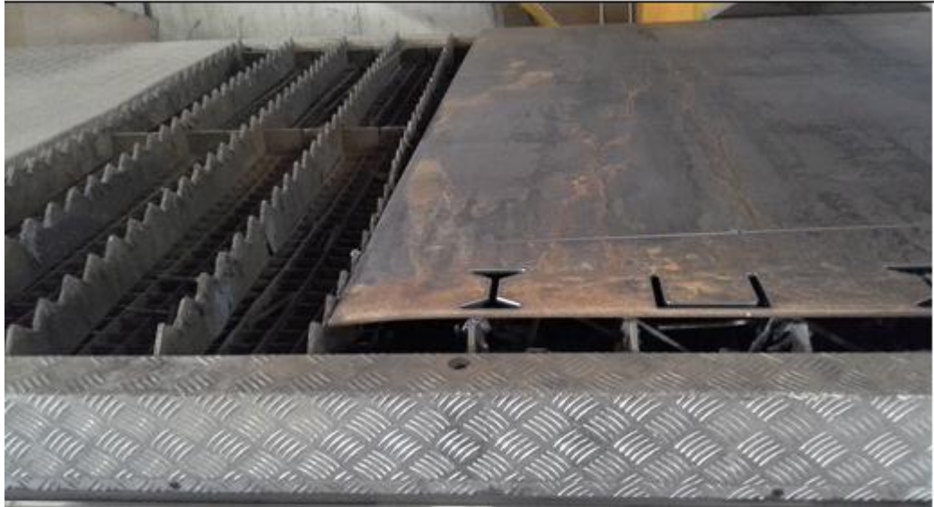
Figure I-4: La mise en place des plaques métalliques sur la table de découpage.
