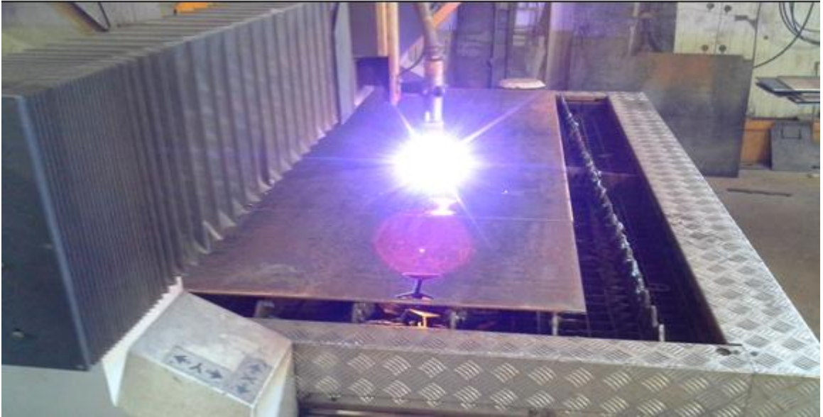
Figure I-3: Plaque métalliques après passe l'utile de plasma
