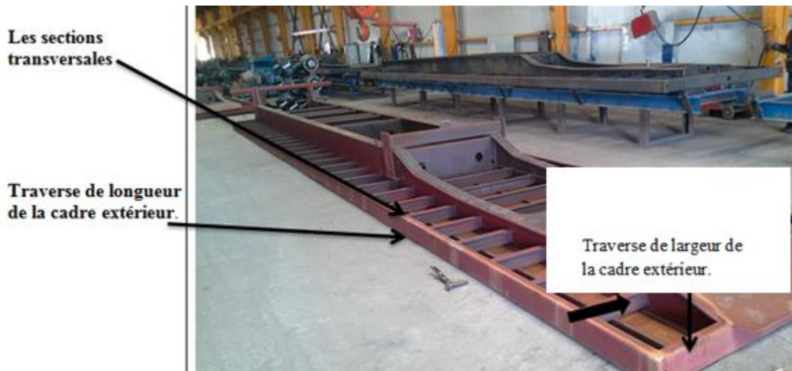
Figure I-14: Châssis après soudé les sections travers -carrosserie ACI
