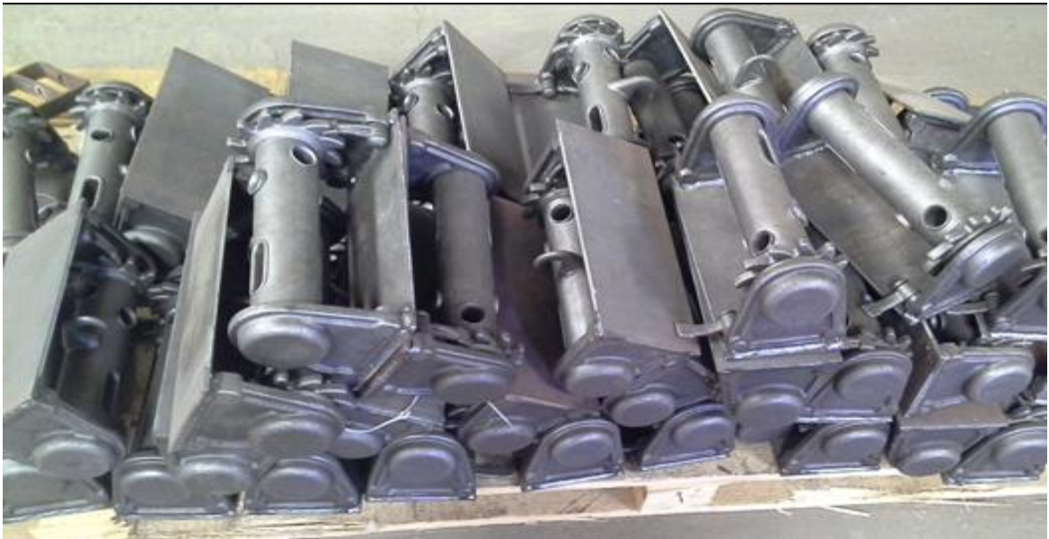
Figure I-22: Dispositifs de serrage des câbles
