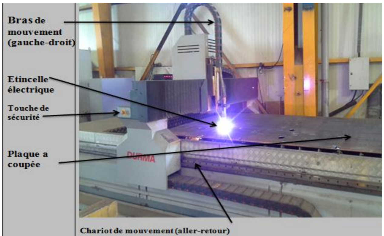
Figure I-5: Découpeuse par plasma.
