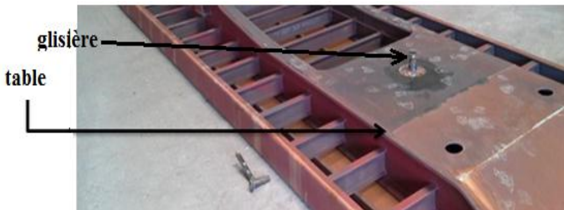
Figure I-15: Soudage de la table glissière -carrosserie ACI de M'sila
