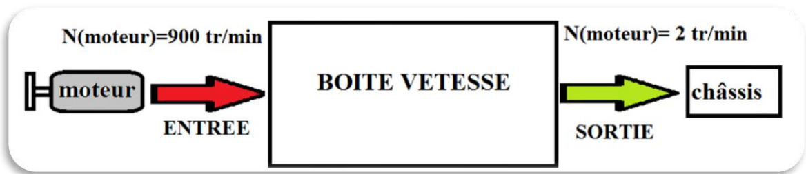
Figure III-11: Principe de réduction de vitesse de rotation
