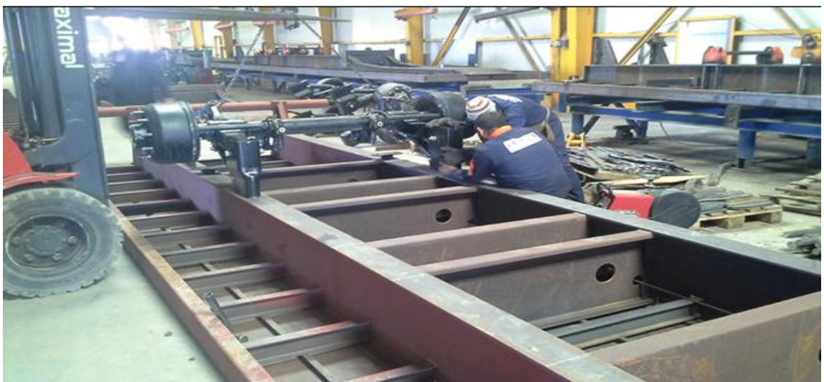
Figure I-20: Soudage les axes des roues.
