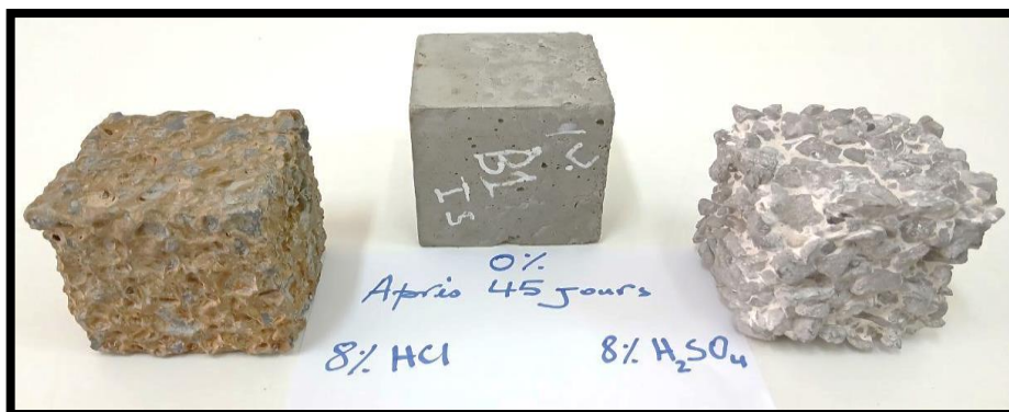
Figure.III.12. Forme des éprouvettes de bétons Après 45 jours d'immersion.
