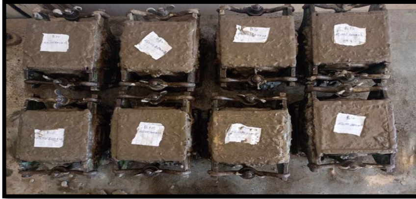
Figure III.8. Confection des bétons étudiés
