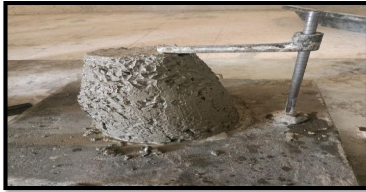
Figure III.9. Essai d'affaissement au cône d'Abrams
