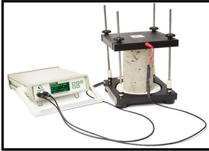
Figure II.13. Dispositif de mesure de la résistivité électrique du béton.
