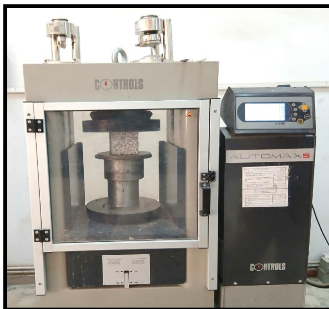
Figure III.12. Machine d'essai de résistance à la compression
