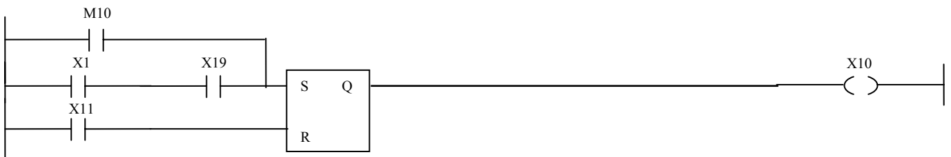
Réseau 20 : l'activation et la désactivation d'étape 10
