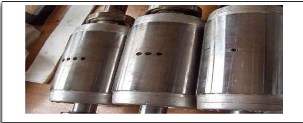
Fig.I.10. Ruptures de barres[21].
