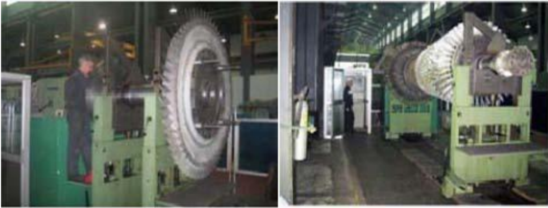
(a) Equilibrage d'une route turbine à gaz (pièce seule)
