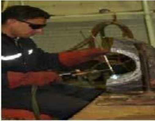
(a) Application par rechargement manuel de métaux antifrictions
