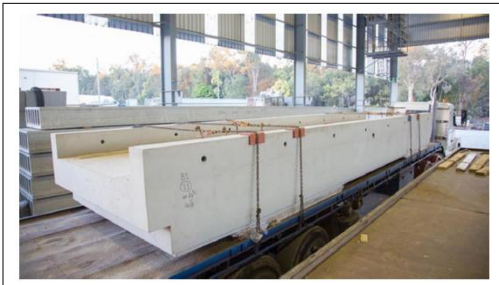
Figure I.45. Poutres en béton géopolymère préfabriqué [198]
