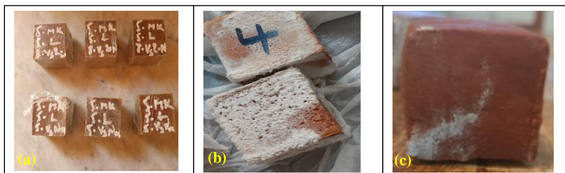
Figure II.9. Éprouvettes cubiques de la pâte géopolymère en fonction de la teneur en MK : (a) Type I, (b) Type II, (c) Type III.
