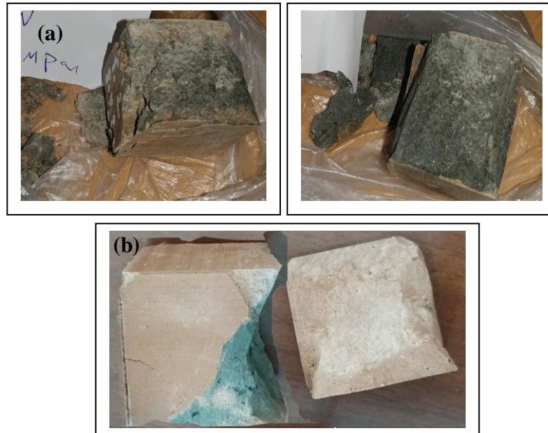
Figure III.2. Éprouvettes cubiques de la pâte pure après écrasement : (a) MK01, (b) MK03
