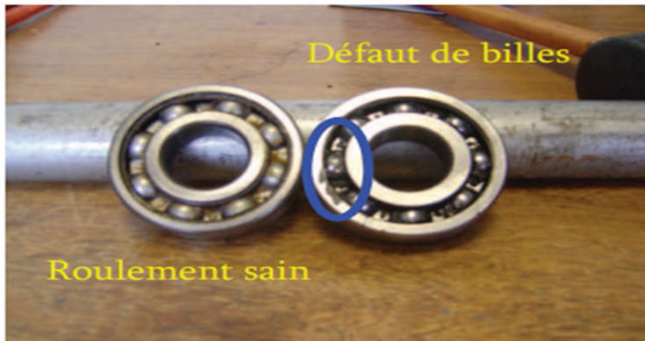
Fig. I.12 : Vue des roulements sains et défectueux (billes écorchées) [4].
