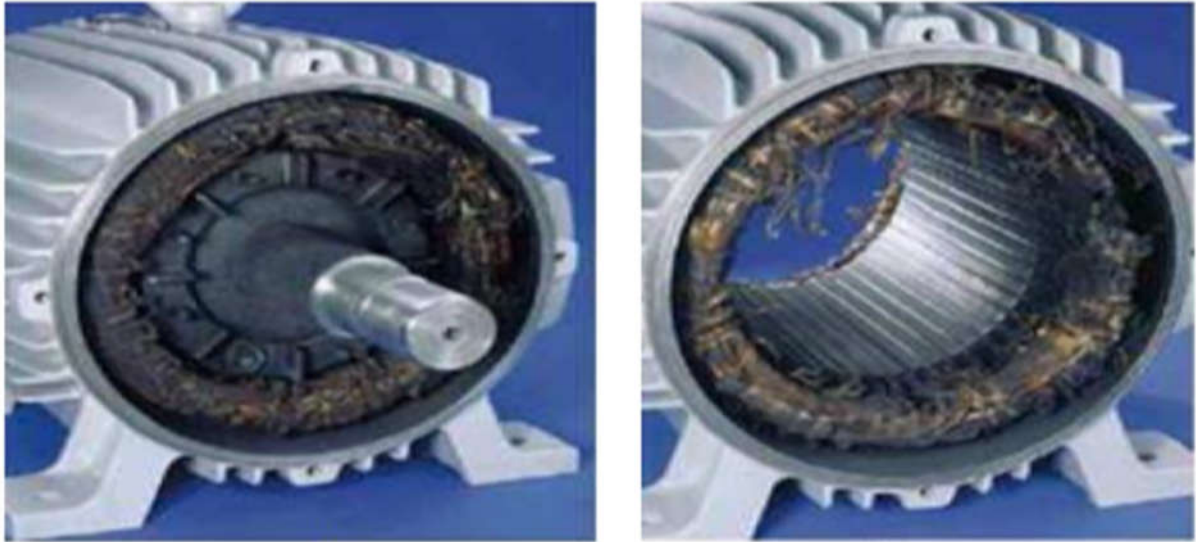
(a) Court-circuit due à un rotor bloqué
