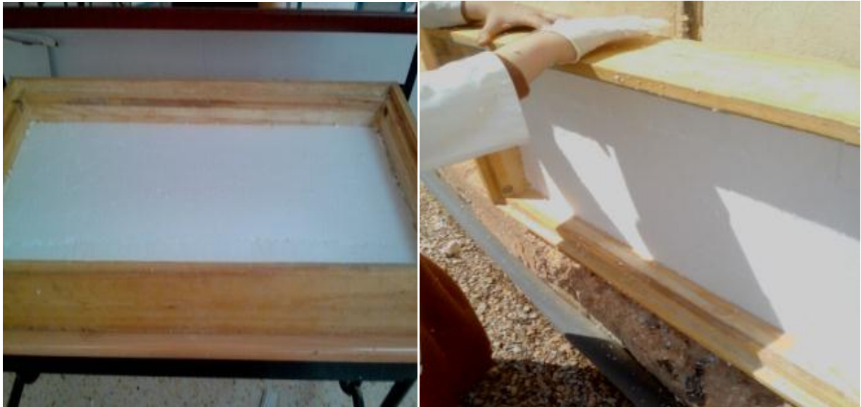
Figure III.7- Coffre avec l'isolant en polystyrène.
