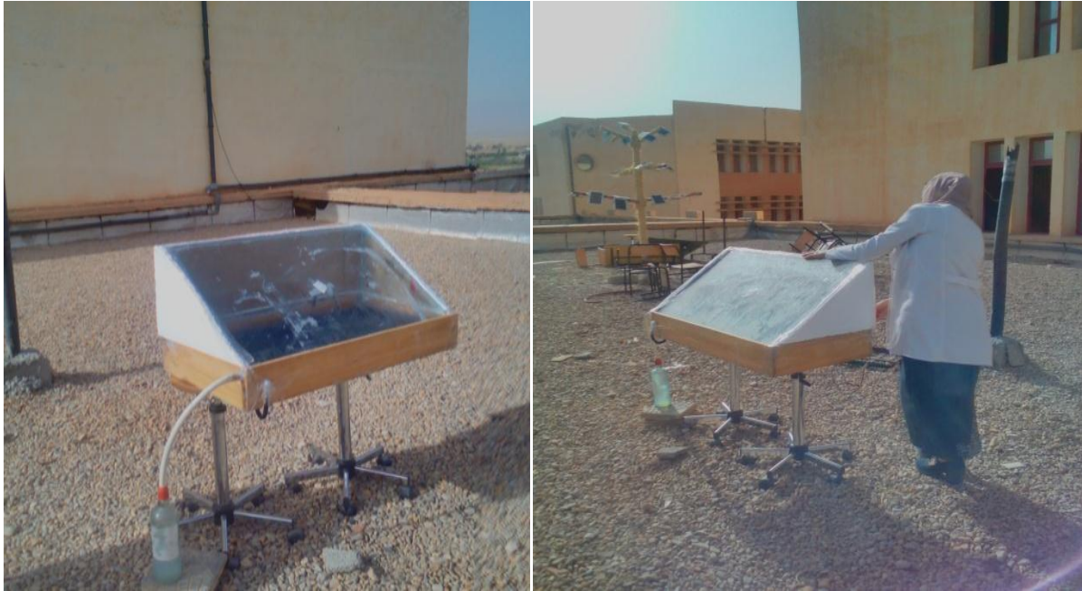
Figure III.4- Installation expérimentale de distillateur conventionnel.
