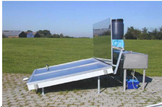
Figure II.2- Distillateur solaire avec un réflecteur externe supérieur [10].
