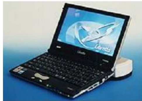
Figure I.5: Pile à combustible au méthanol Toshiba (2004), autonomie = 20h, poids = 900g
