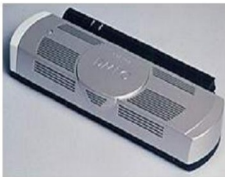
Figure I.5: Pile à combustible au méthanol Toshiba (2004), autonomie = 20h, poids = 900g
