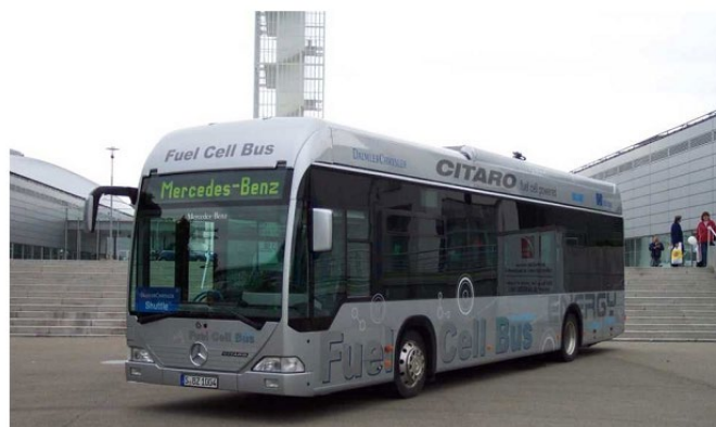
Figure I.7 : Bus Mercedes Citaro fonctionnant avec une PEMFC
