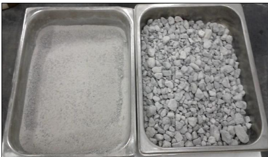
Figure I.16. Essai de résistance à l'abrasion d'un granulats recyclé (Los Angeles) [TOU 19].
