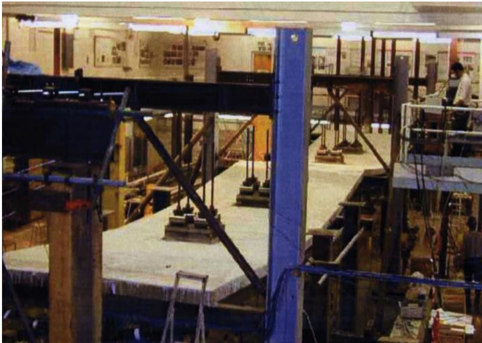
Figure I-1 : Vue du portique après défaillance [9]
