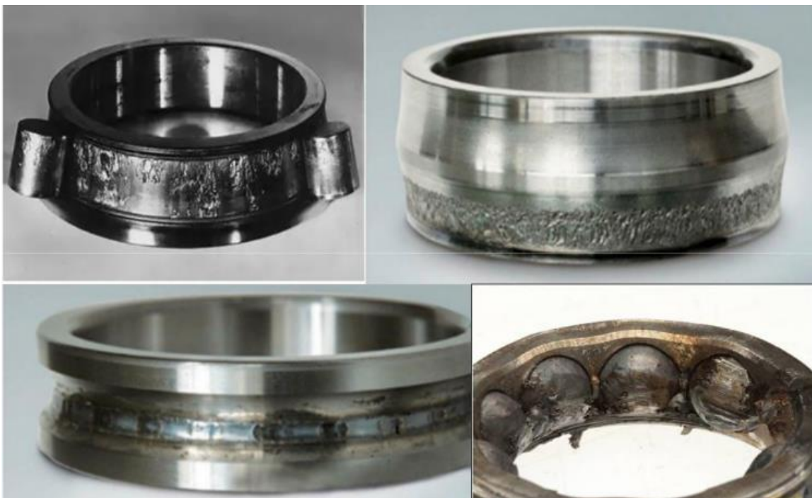
Figure II.8 : Quelques défaillances affectant les roulements.
