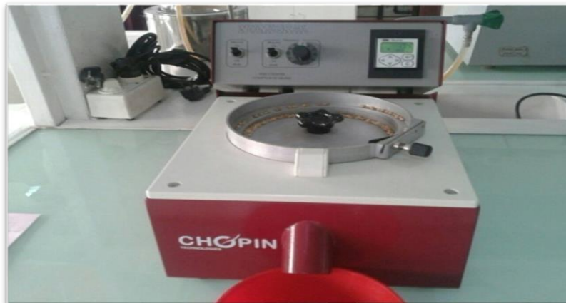
Figure 2: Compteur des grains(NUMIGRAL12407CHOPIN.France)
