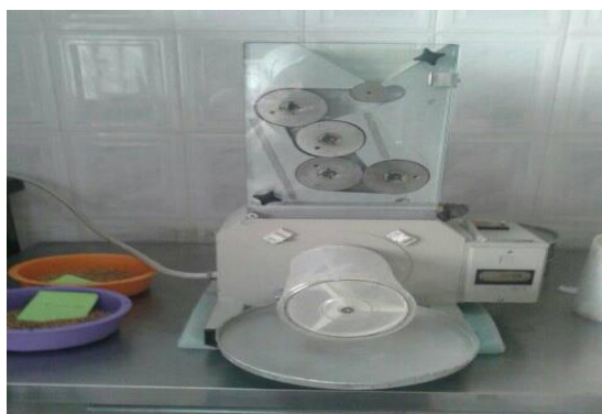
Figure 3: moulin de laboratoire(BRABENDER880508.Germany)
