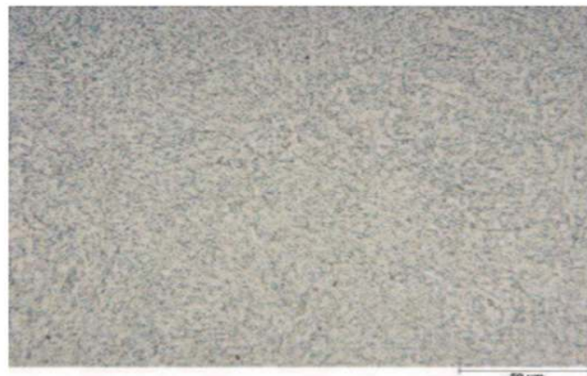
Figure .II.6: structure d'un acier AISI H11 à l'état recuit
