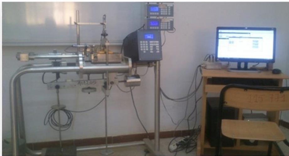
Fig III.4: Appareil de cisaillement direct (Université de M'sila, Département de Genie civil, Faculté de Technologie)
