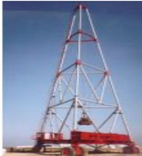
Fig : I.14 - Engin utilisé pour la réalisation des plots ballastés (Document de Ménard Soltraitement®)
