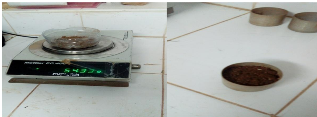
Figure 06 : Mesure de l'humidité de sol
