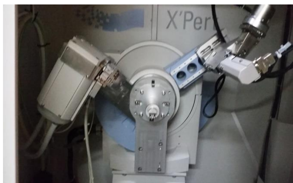
Figure.III.13. Diffractomètre au rayons X de type X'Pert Pro SW
