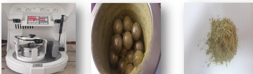
Figure.III.11. Broyage Des fibres
