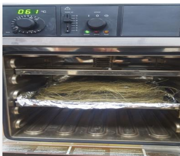
Figure.III.8. Fibres séchées à l'étuve après extraction
