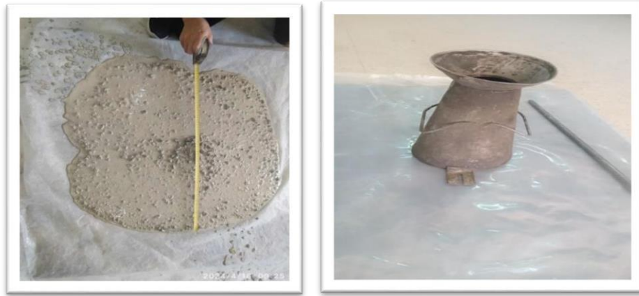
Figure 4 : Essai d'étalement au cône d'Abram's selon la norme SN EN 12350-8.
