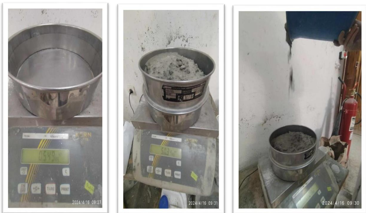
Figure 17 : Principe de l'essai stabilité de tamis sur BAP
