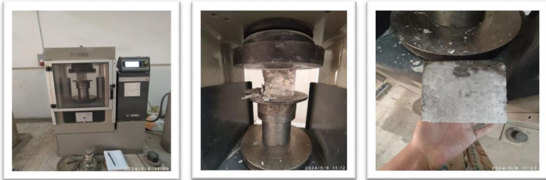
Figure 19: Essai compression : a) machine et éprouvette, b) éprouvette destructeur.
