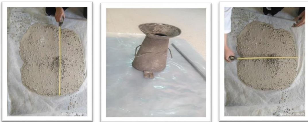
Figure 16: Essai d'étalement au cône d'Abrams's
