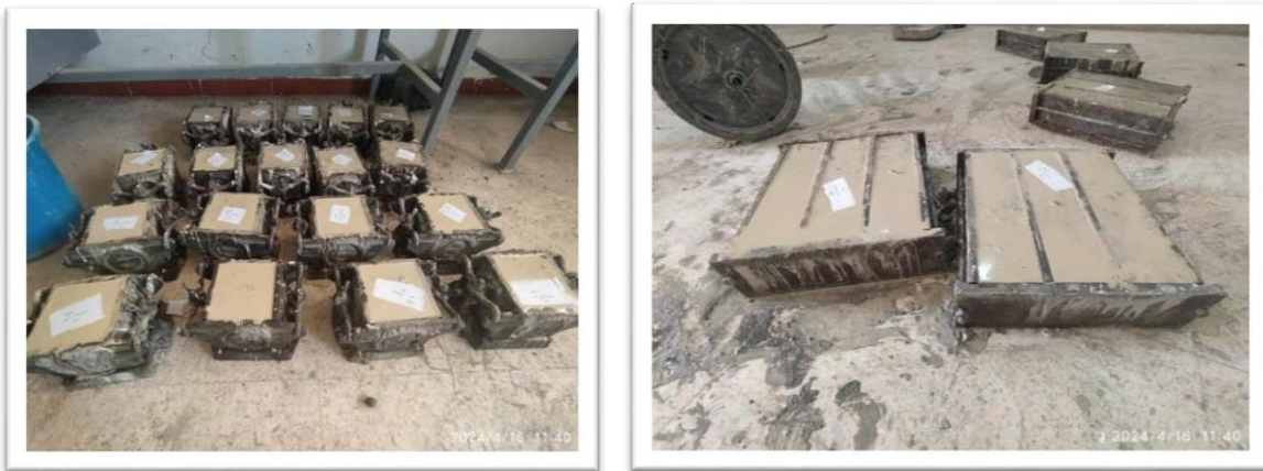
Figure 22 : Type des éprouvettes utilisés :a) prismatique, b) cubique
