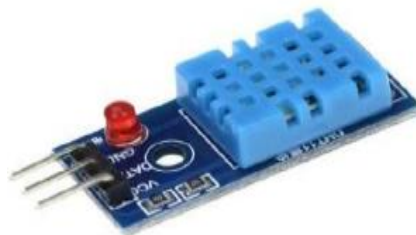
Figure III-10. Capteur de température et d'humidité de l'air (DHT11).
