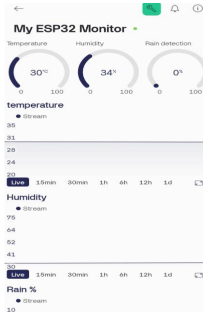
Figure III-26. Interface d'application pour afficher les données de température, d'humidité et de détection de pluie en temps réel.
