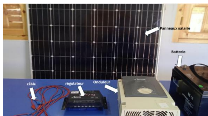
Figure III-14. Les composants électriques.
