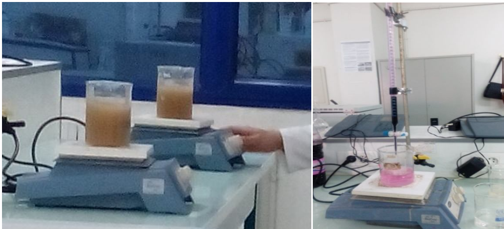
Figure 17: Dosage du calcaire actif.
